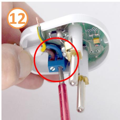
12 Зафиксируйте провода в клеммнике на плате.
