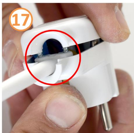
17 Закрепите фиксатор провода винтами.
