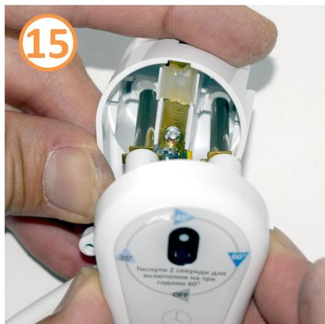
15 Поправьте контактные штифты и вставьте их в отверстия корпуса.
