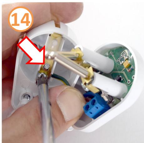
14 Установите центральный винт корпуса и затяните клемму. (Винт предотвращает проворачивание контактной площадки)
